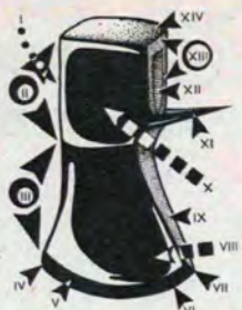
Části sekery: I — čelo, II — hlava, III — čepel, IV — nos, V — břit, VI — ostří, VII — pata, VIII — líce, IX — týl, X — spánek, XI — brada, XII — oko, XIII — týl, XIV — čepec.
